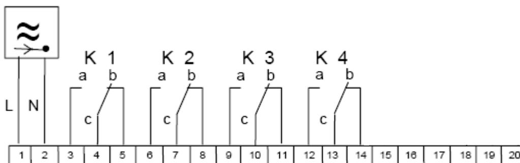
Betriebsspannung: 230 V<sub>AC</sub>
