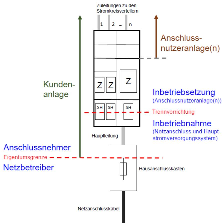
**Bild 4.1** Beispielhafte schematische Darstellung der Begriffe Inbetriebnahme / Inbetriebsetzung sowie Kundenanlage / Anschlussnutzeranlage am Beispiel eines Netzanschlusses im Gebäude ohne Anschlusschrank im Freien
